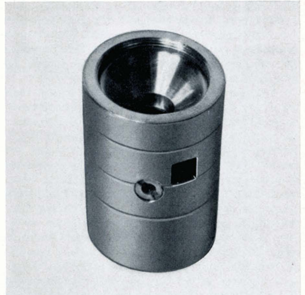
Bild 2 Objektivpolschuhsystem mit Stigmator der Einrichtung für Reflexionsmikroskopie
