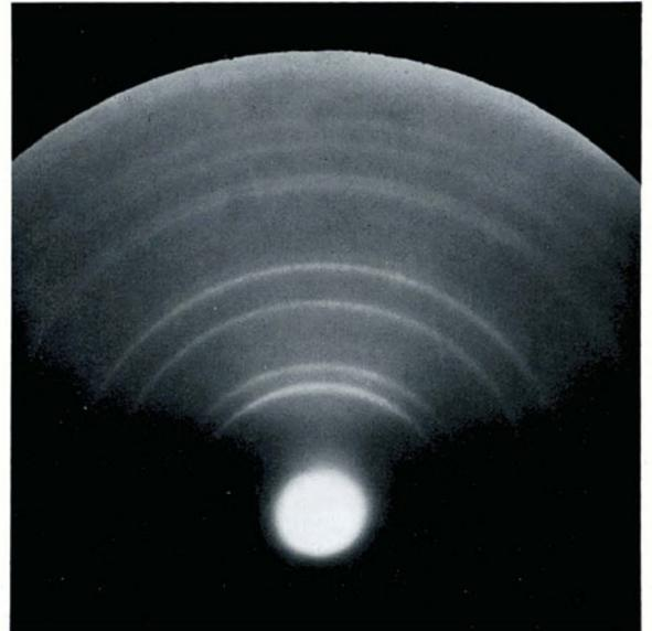
Bild 3 Reflexions-Beugungsdiagramm von Nickel, aufgenommen bei einer Beschleunigungsspannung von 80 kV
