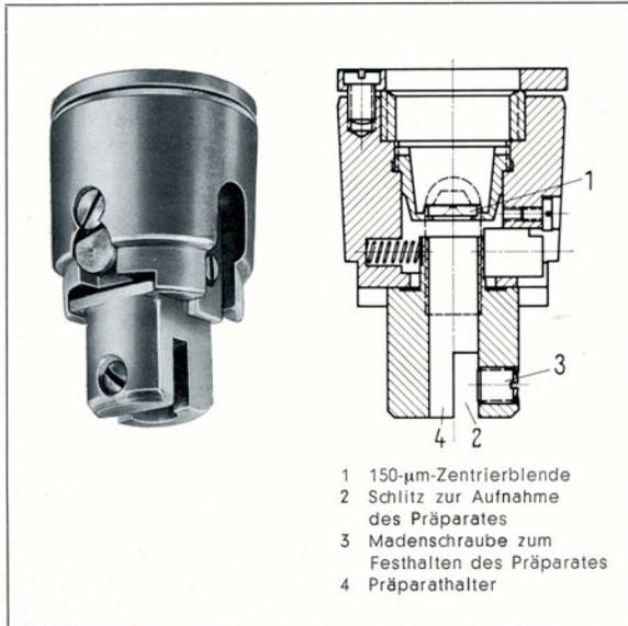
Bild 1 Objektpatrone für Reflexionsbeugung, L.-Nr. 171 112
