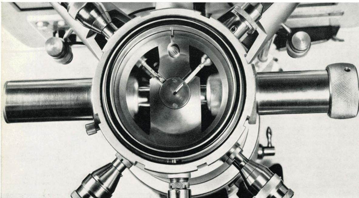
Bild 6 Blick von oben auf die geöffnete Mikroskopröhre. Im Schleusengehäusr ist der Blendenkäfig für die Vorblende sichtbar
