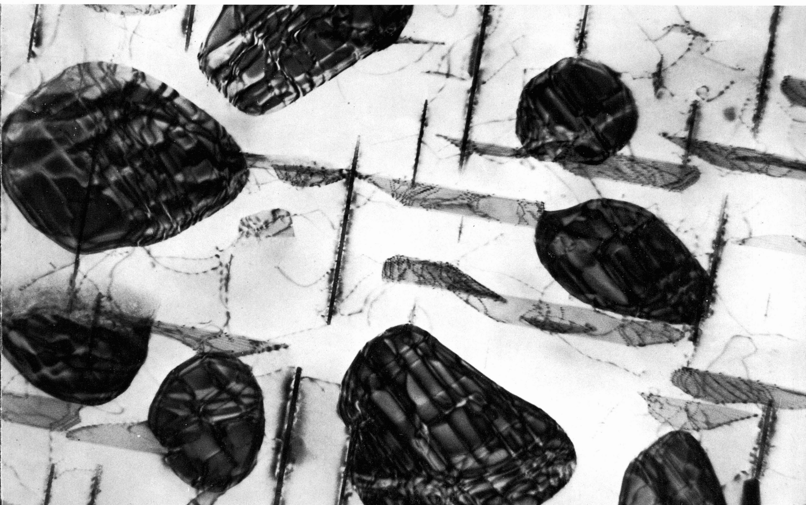
▼ Ausscheidungen ( \theta' -Phase) und Versetzungen in Legierung Al + 4% Cu Elektronenoptische Vergrößerung 25 000fach Gesamtvergrößerung 80 000fach Strahlspannung 125 kV
