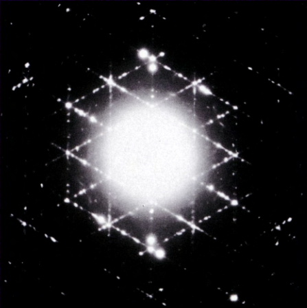
Diagramme de diffraction d'un cristal d'oxyde d'aluminium, avec reflets dus à une superstructure
