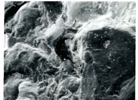
Schweißnaht auf der Röhre Vergrößerung 150x
